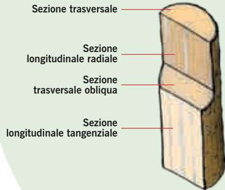
A seconda della direzione e posizione di taglio del tronco si evidenzia un particolare disegno del legno (marezzatura o venatura) che insieme alle proprietà tecnologiche di resistenza, durezza, lavorabilità e colore determina la qualità commerciale delle specie legnose.
